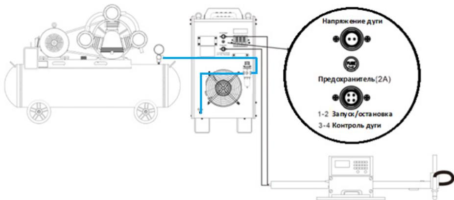
На задней панели аппарата имеются следующие разъемы подключения:
