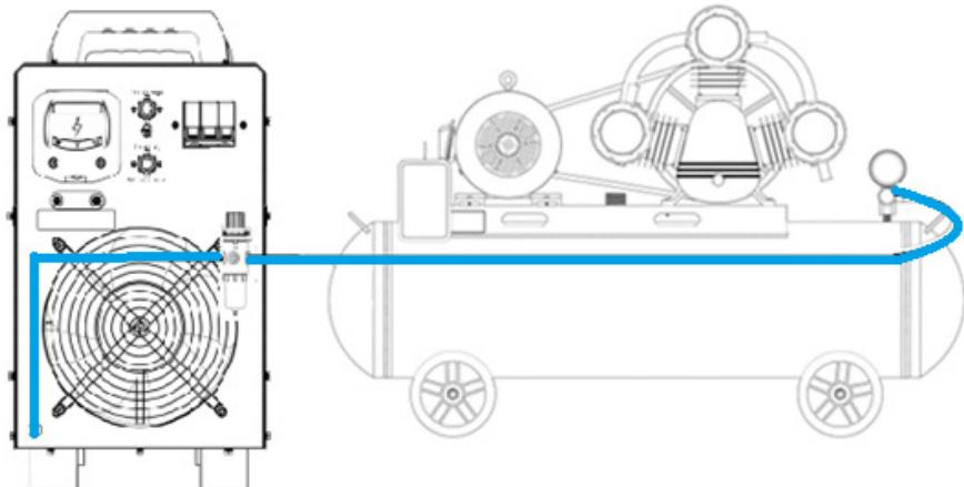
1. Подсоедините шланг от компрессора /пневмосети к впускному патрубку узла подготовки воздуха на задней панели аппарата и зафиксируйте его. Шланг, подключенный к выпускному патрубку подсоедините к штуцеру, расположенному в нижней части задней панели аппарата.
