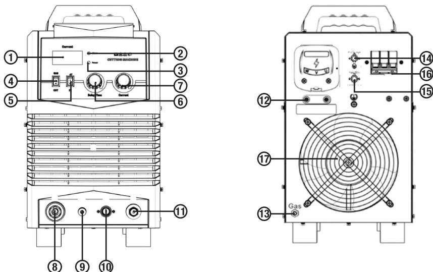
1. **Цифровой дисплей:** отображает значения тока резки.
