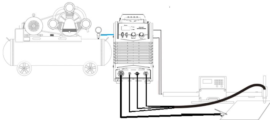
Подключение плазматрона и зажима обратного кабеля к передней панели аппарата осуществляется в той же последовательности, как и при ручном режиме плазменной резки.
