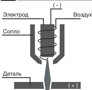
Плазма представляет собой газ, нагретый до сверхвысокой температуры, ионизированный настолько, что он становится электропроводящим. В качестве плазмообразующего газа используется воздух, поступающий от компрессора или пневмосети.
